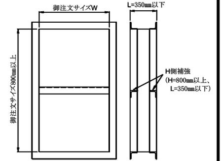
※H寸法が800mmを超えL寸法が350mm以下は両サイドに補強が1本ずつ入ります
